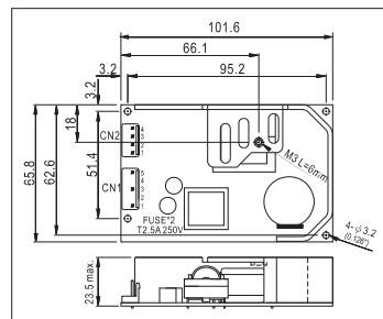
AC input voltage range .... 88~264VAC; 120~370VDC
