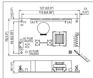
AC input voltage range .... 90~264VAC; 120~370VDC
