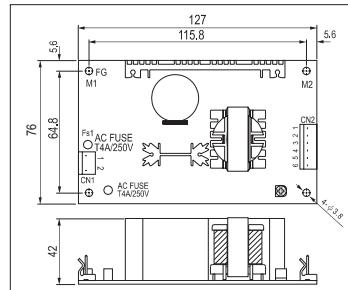
AC input voltage range .... 90~264VAC; 127~370VDC
