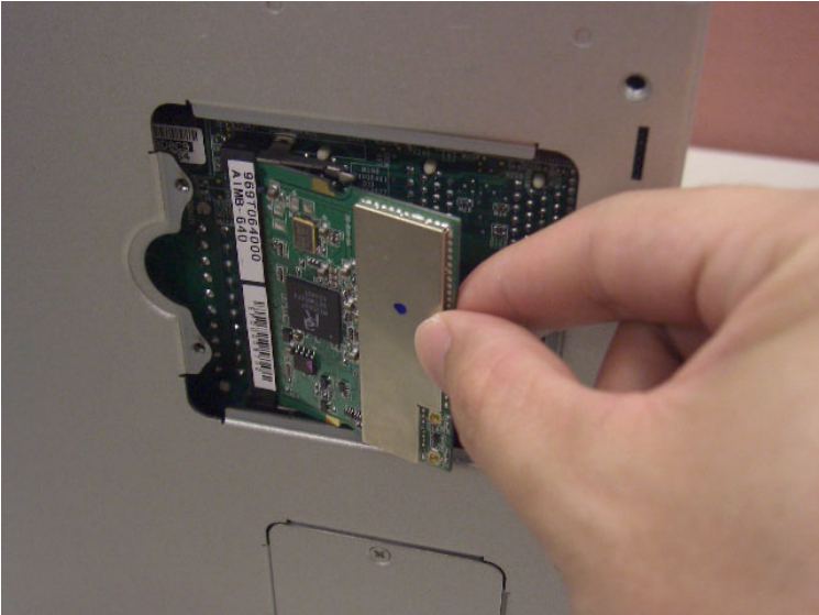
Figure 3.8: Insert the Mini PCI extension card into the Mini PCI slot
