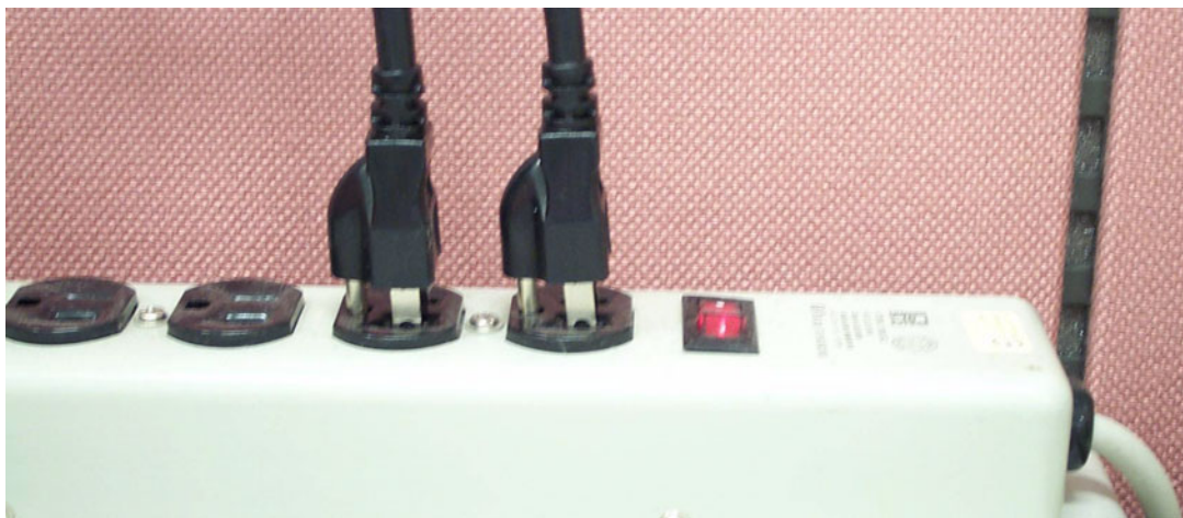
Figure 3.14: Orientation of power cord plugs/ 插座上电源线方向应相同 / 插座上的電源線方向應相同
