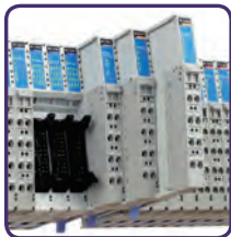
Slice Type I/O Modules
