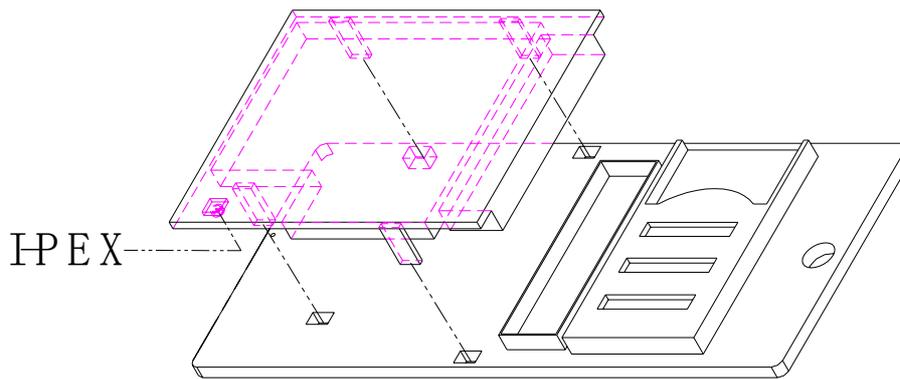
**Figure 5.2 Install Wavecom module on AMO base board**
